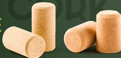
**FineCork® est un bouchon technologique de nouvelle génération** composé de micro-granulés de liège, obtenu par moulage individuel après ajout de microsphères expansibles. La taille du micro-granulé est de 0,5 à 1 mm. Pour libérer le liège des substances à l'origine du "goût de moisi" appelé communément "goût de bouchon", le liège est traité par un "courant de vapeur" grâce au procédé breveté "Genesis®".
